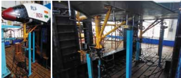
Fig.5 Structural Testing of RLV EM
